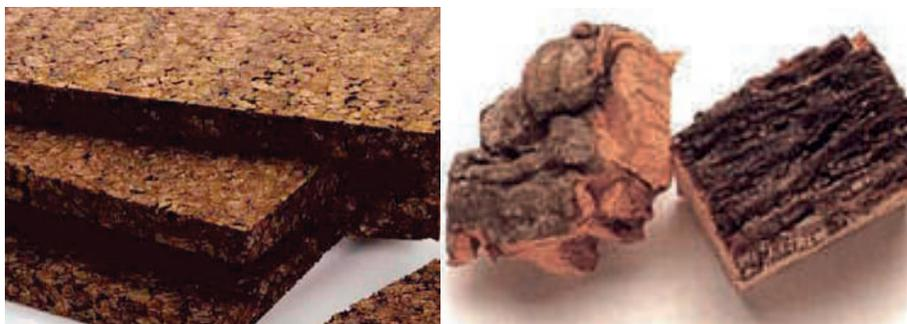
Figure 61.- Plaques de liège aggloméré et expansé (ICB)
