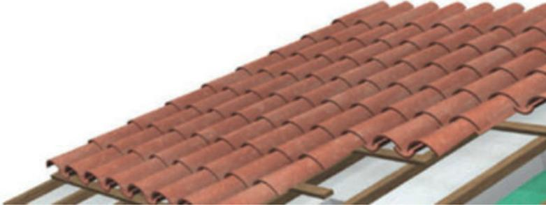
Figure 22.- L'isolation avec de l'EPS en toiture inclinée
